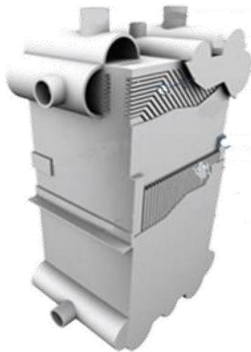
图 1.板翅式换热器结构示意图
