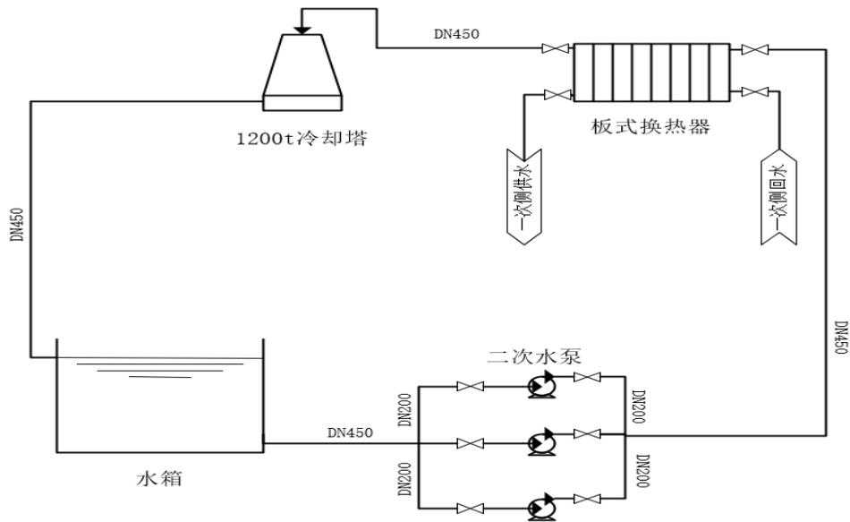
图 1 离子回旋冷却塔回路P&ID流程图
